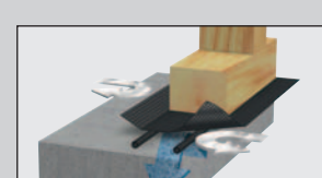
DELTA®-VENTSTOP Bande d'arase assurant l'étanchéité à l'air entre le plancher béton et la lisse basse bois (MOB).
