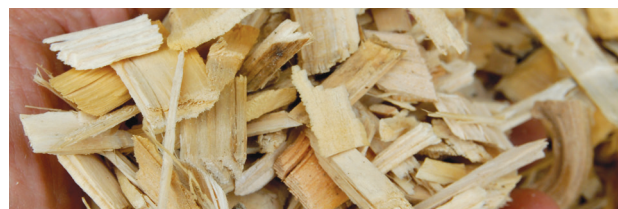
Les plaquettes sont utilisées dans les appareils à alimentation automatique.
