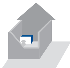
PAC placée dans une cour : intérieure : + 9 dB(A)
